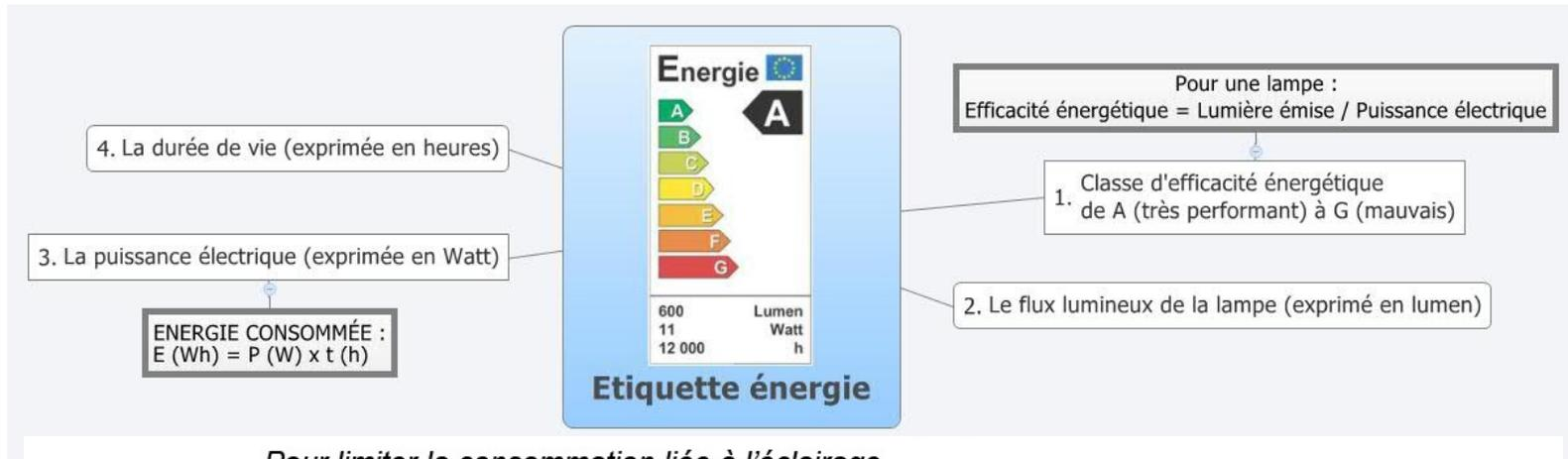
*Pour limiter la consommation liée à l'éclairage, on peut trouver différentes solutions techniques pour distribuer l'énergie électrique*
